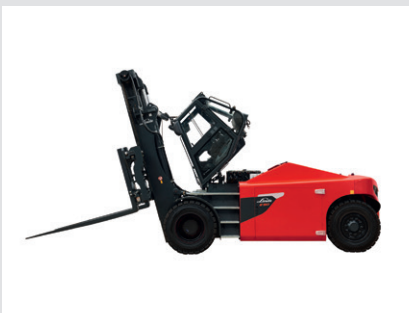
Servicezugang durch kippbare Kabine
